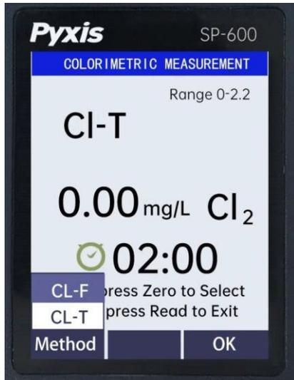
Figura 1. Pantalla colorimétrica para la medición de DPD Pantalla colorimétrica para la medición del cloro libre o total DPD
