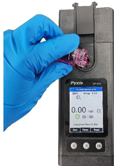
Figura 4. Transferir la muestra revelada a la cubeta de muestra
